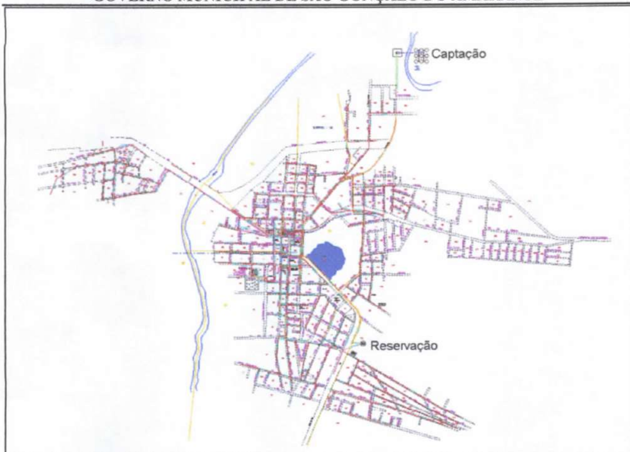
Figura 5-2: Sistema de abastecimento de água do distrito Sede. Fonte: CAGECE.
