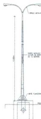
02 Detalhe do Poste Para Rameado Externo Utilizado Para OPT
