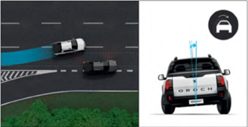
sistema anticapotamento Aumenta a estabilidade do veículo quando o risco de capotamento é alto.
